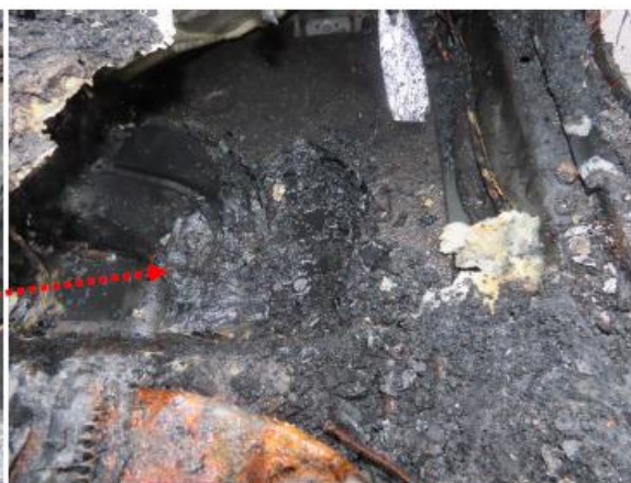
Foto 17 viser de laveste brandskader i kabinen.
