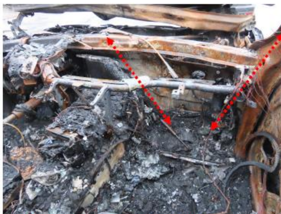
Foto 14 viser brandvifte i området foran højre forsæde.
