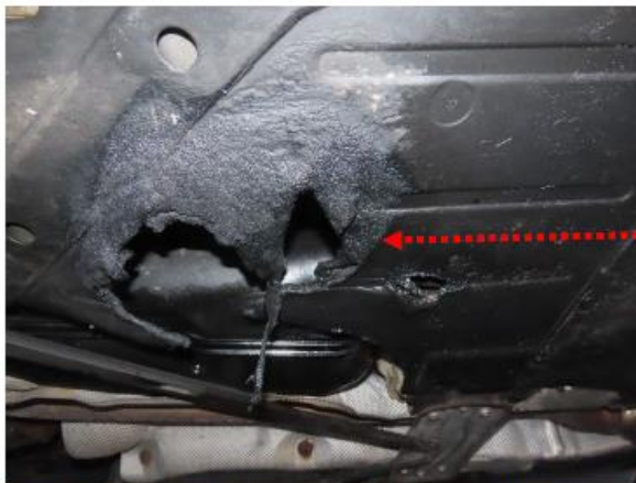
Foto 25 & 26 viser brandskader under bilen i området ved bilens brændstoftank.
