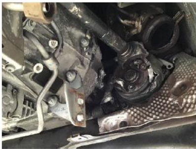
Foto 1. Defekt drivaksel, og defekt katalysator.
