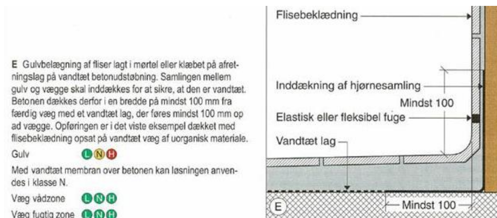
Figur 3 – uddrag fra 'By og Byg Anvisning 200, Vådrum' s. 37 vedr. eksempler på samlinger mellem gulv og vægge ifbm. betonudstøbninger.
