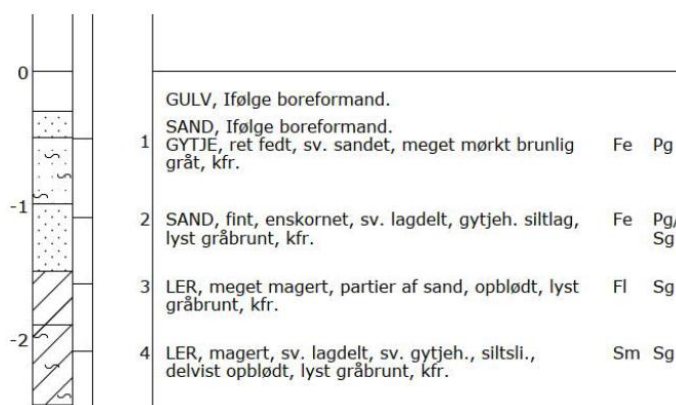
Figur 2. Uddrag fra geoteknisk boring fra ref. 1.
