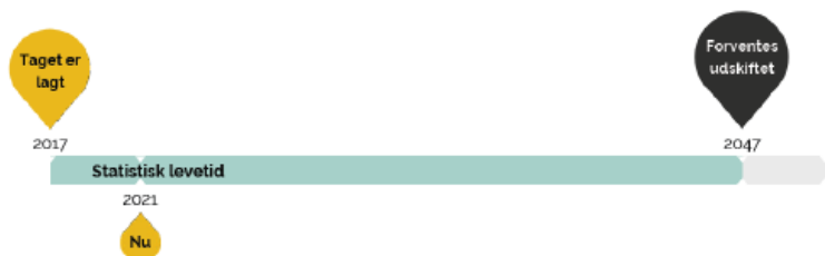
Tagbelægning - Eternitbølgeplader uden asbest
